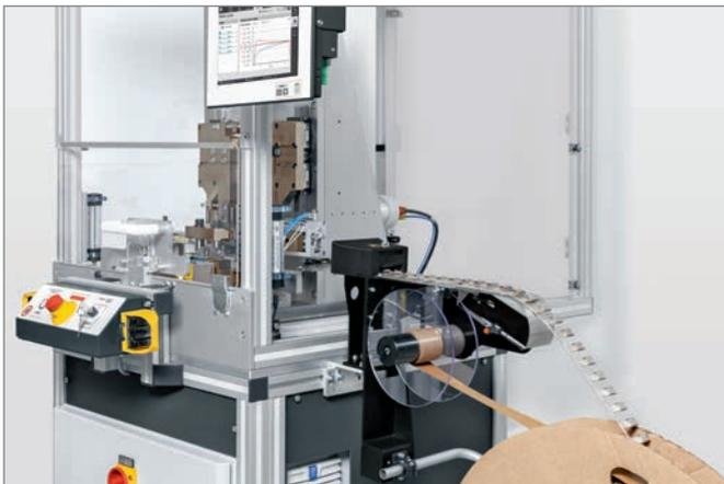
La aplicación se ha realizado en un equipo de soldadura lineal por ultrasonidos del modelo MPX, con una frecuencia de 20 kHz, y en el dispositivo especial correspondiente.
