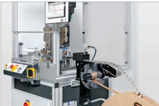
L'applicazione è stata realizzata su un impianto di saldatura a ultrasuoni lineare di tipo MPX, frequenza 20 kHz, e relativo dispositivo speciale.
