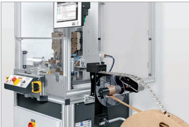
La aplicación se realizó en el equipo de soldadura por ultrasonidos MPX-RT con alimentador automático.
