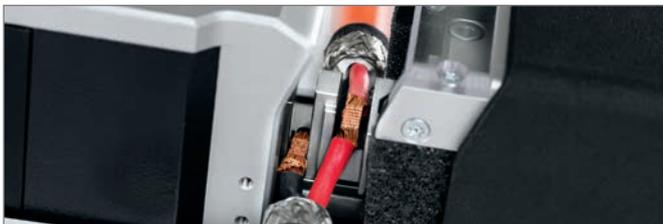
Las aplicaciones se realizan en un sistema de soldadura de cables por ultrasonidos Telso®Splice TS3 con posición de acomodo integrada mediante un sistema de control de procesos con manejo por pantalla táctil y software guiado por menús.
