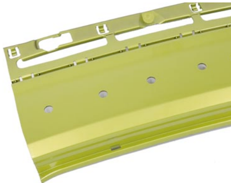
Bild Nr. 27-03 TC_Sonigtwist_gruen.jpg Weil die Sonotrode nicht in das lackierte Teil eindringt, kann dessen Materialstärke wesentlich geringer gestaltet werden. Bei einem Stoßfänger für ein Serienfahrzeug kann die Wandstärke beispielsweise um bis zu 20 % geringer ausfallen.
