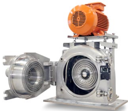
Bild Nr. 30-03 TC_Anu-Muehle_offen.jpg Ein besonderer Materialmix sorgt dafür, dass die Stifte die Drehzahlen unbeschadet mitmachen und so die hohe Geschwindigkeit der Universal-Stiftmühle UM 315 ermöglichen.
