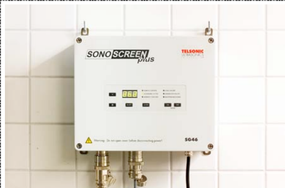
Bild Nr. 30-04 TC_Sonoscreen+.jpg Das Siebsystem der Schweizer Telsonic AG lässt sich an unterschiedlichste Siebsituationen anpassen. Mit Voreinstellungen für verschiedene Pulverarten lassen sich dabei Produktivitätssteigerungen im zweistelligen Prozentbereich erzielen.
