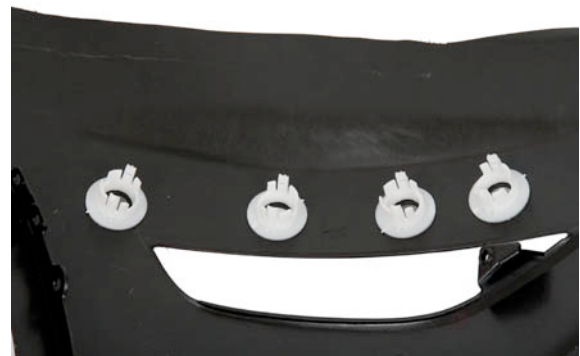
Bild Nr. 25-04 TC_Soniqtwist_black.jpg Die zu verschweißenden Teile können ohne besondere, zusätzliche Maßnahmen zur Gestaltung der Fügefläche konstruiert werden..
