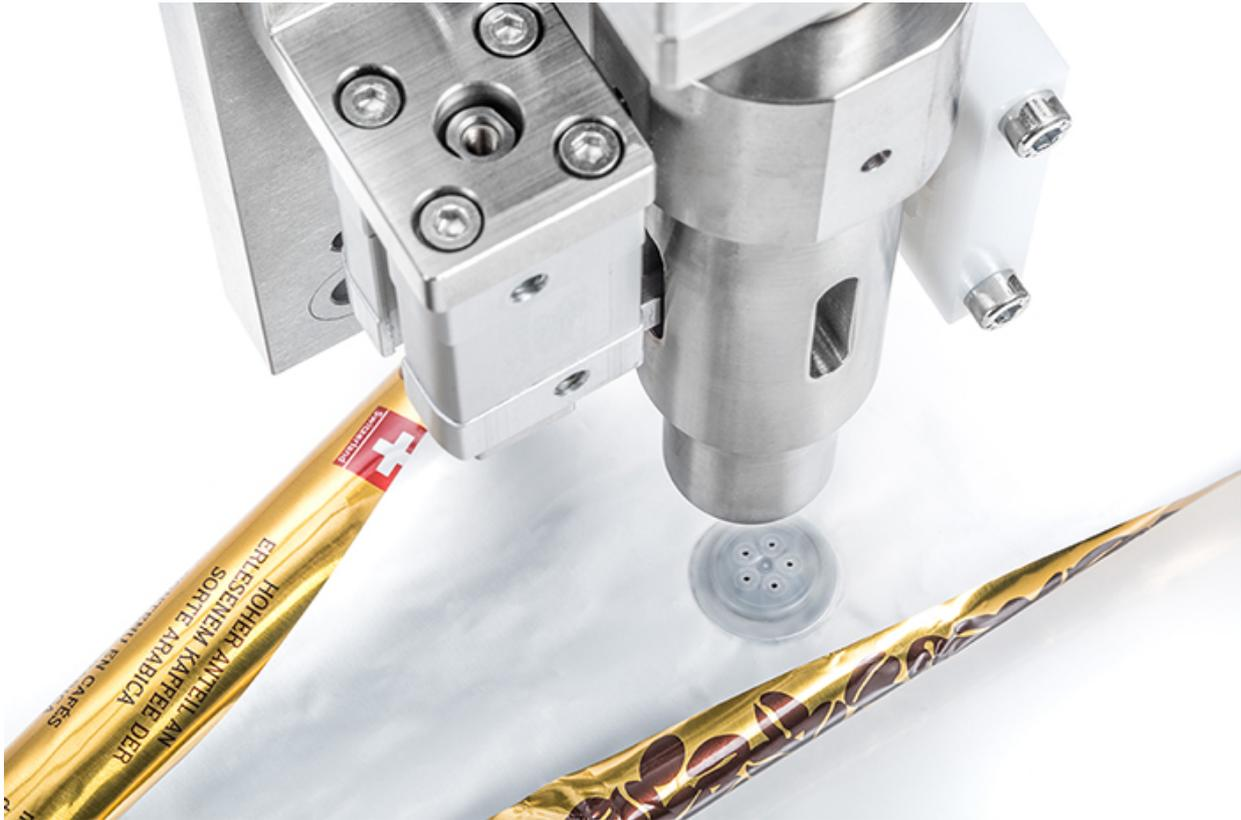
Anlage, die Entgasungsventile auf flexible Kaffee Verpackungsfolien aufschweisst
