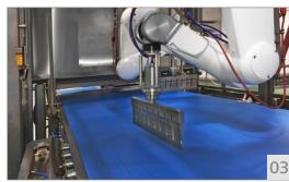
01 La nuova lama da 760 mm Telsonic migliora ulteriormen 02 te l'efficienza e la produttività dei sistemi a ultrasuoni
