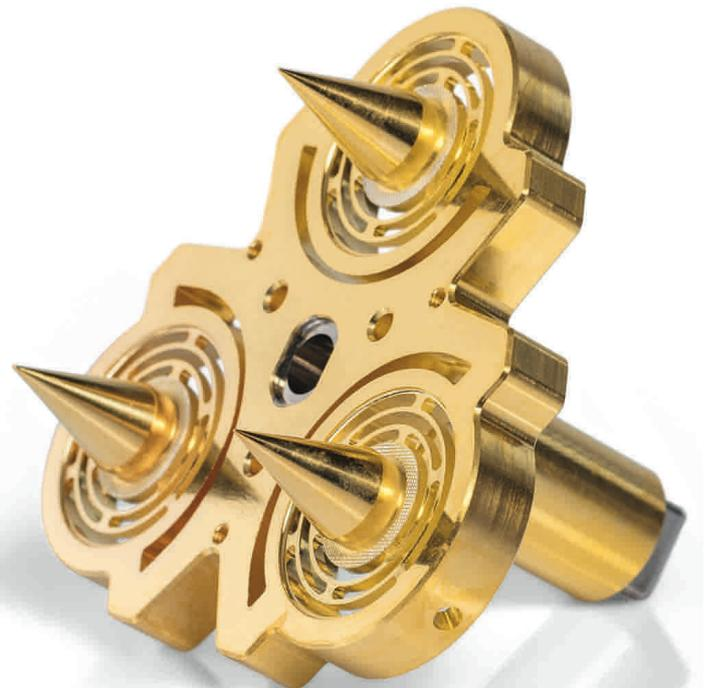
01 Drei kegelförmige Körperelemente aus einem 0,13mm dicken Silberträger, innen geschwärzt und außen vergoldet. Mit hoher Genauigkeit und großer Langzeitstabilität kann es Wärmeflussdifferenzen messen, die durch die absorbierte Sonnenstrahlung entstehen.
