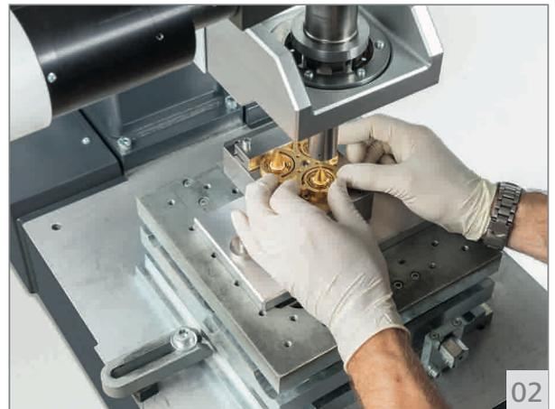
02 Das von TELSONIC entwickelte und patentierte torsionale Schweißverfahren vermindert den ungewollten Schwingungseintrag in das Schweißobjekt stark.
