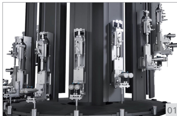
01 La tecnologia a ultrasuoni può essere facilmente integrata nei sistemi di automazione ad alta velocità utilizzati nella produzione di celle cilindriche per batterie EV agli ioni di litio
