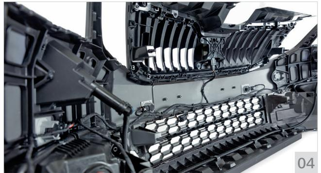
04 Das torsionale Schweißen SONIQTWIST® von Telsonic ist im Serieneinsatz bei Skoda seit 2019.
