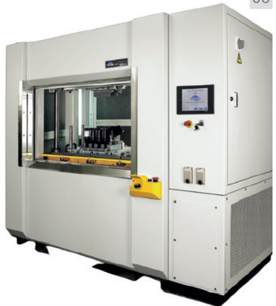
06 다양한 크기의 복잡한 3D 성형 플라스틱 부품을 접합하기 위한 진동 용접 시스템
