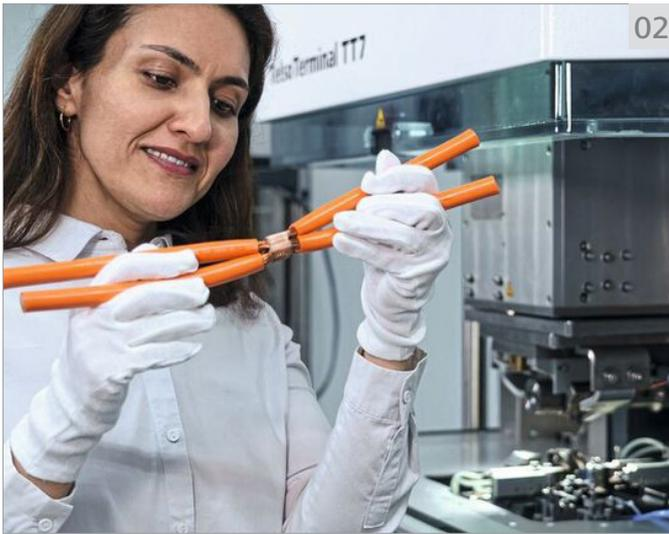
02 Shimaalsadat Mostafavi, director del laboratorio de metales y arquitecto de aplicaciones de Telsonic: «Próximamente también podremos soldar cables de aluminio. Y en cuanto a las secciones transversales, con 280 mm<sup>2</sup> aún no hemos llegado al límite de lo posible».
