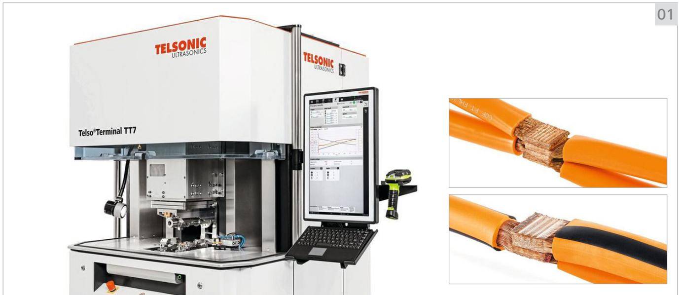
**01** Il sistema Telsonic per la saldatura di cavi di sezione spessa mediante ultrasuoni utilizza una combinazione di diversi approcci tecnici: tecnologia PowerWheel, misurazione della forza di saldatura effettivamente applicata, potenza del generatore di 14,4 kW per tempi di ciclo brevi, maschere e utensili speciali che impediscono lo scivolamento dei cavi e molto altro ancora. Combinazioni realizzate fino ad oggi: fino a cinque cavi in rame con una sezione totale fino a 280 mm<sup>2</sup>.
