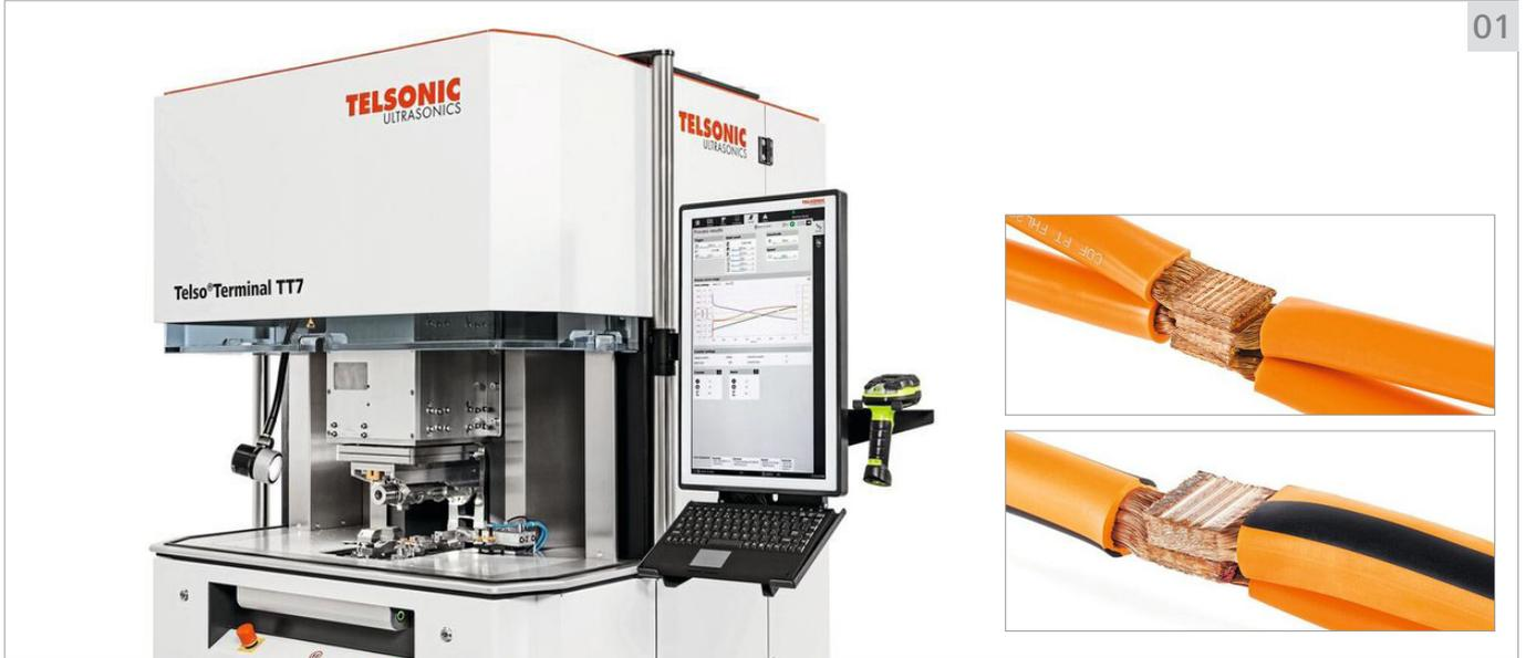
01 텔소닉 초음파 용접 시스템은 두꺼운 케이블 단면적을 용접하기 위해 다양한 기술적 접근 방식을 결합합니다: 파워필 기술, 실제 적용된 용접 힘 측정, 짧은 사이클 시간을 위한 14.4kW 발전기 출력, 케이블 미끄러짐을 방지하는 특수 마스크 및 도구 등.
