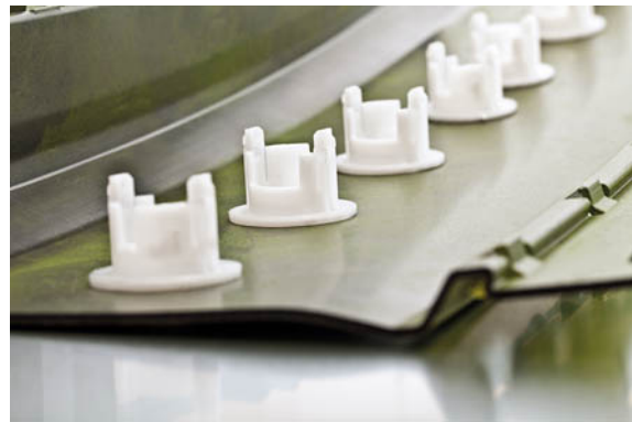
Bild Nr. 34-02 TC_AS-Sensorhalter.jpg. Mit SONIQTWIST® von TELSONIC werden Sensorhalterungen fest, sicher und ohne Abzeichnungen in lackierte Stoßfänger eingeschweißt.
