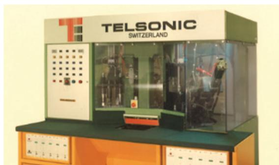
Equipo de soldadura multiconvertidor
