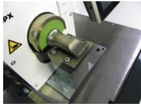
**(Verschiedene Werkzeugstirnkonfigurationen (einfach und dreifach) ermöglichen während des Projekts den Vergleich und die Beurteilung der geschweissten Materialien)**
