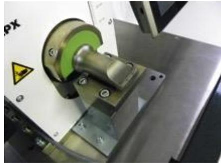
**(Dos configuraciones distintas de las caras de las herramientas, simple y triple, permiten evaluar y comparar las soldaduras a lo largo del proyecto)**
