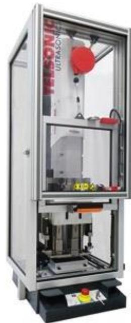
**(Los embellecedores de las carcasas de los controles de las ventanas del Jaguar X760 se producen con las prensas ultrasónicas USP2000 de Telsonic)**
