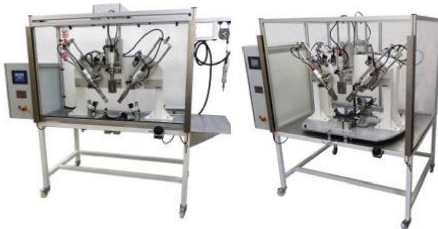
**(El primer montaje parcial se lleva a cabo en la máquina mostrada a la izquierda. La máquina de montaje final [derecha] tiene integrados 6 actuadores de carrera larga y 20 kHz que permiten producir las versiones para vehículos con el volante a la derecha o a la izquierda)**
